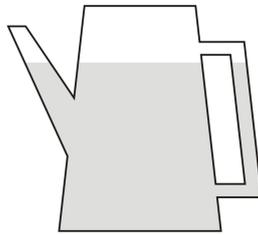
Das liegt daran, dass der Luftdruck als äusserer Druck  $p_a$  auf das Wasser im Wasserbehälter, im Ausgussrohr und im Henkel gleich ist und der Druck in der Verbindung zwischen kommunizierenden Gefässen nur durch die Wassertiefe und den Luftdruck bestimmt ist.
