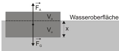
Die Gewichtskraft eines zylindrischen Körpers ist  $F_G = \rho_K \cdot V \cdot g$  und der Luftdruck auf die Deckfläche ist  $F_D = p_a \cdot A$ . Sie drücken nach unten, während der Luft- und der Schweredruck auf die Bodenfläche, die zusammen  $F_B = p_a \cdot A + \rho_F \cdot g \cdot x \cdot A$  betragen, nach oben drücken.
