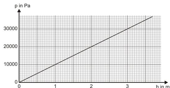
setzt sich aus einem allfälligen äusseren Druck  $p_a$  und dem Schweredruck der Flüssigkeit gemäss (2) zusammen. Normalerweise ist im Alltag der äussere Druck der Schweredruck der Luft, sodass sich der Gesamtdruck aus dem Luft- und dem Wasserdruck zusammensetzt. Der Luftdruck ist etwa 1 bar, und der Wasserdruck nimmt pro 10 m um ungefähr 1 bar zu.
